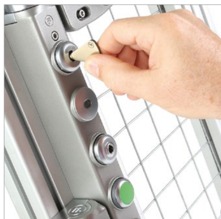
tGard mit Sicherheitsschlüssel zur Entnahme und zum Schutz vor unbeabsichtigtem Wiedereinschalten
